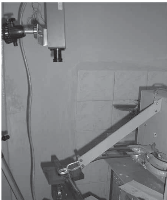
Рис. 15. ЛТО наплавлення на бокових поверхнях рейки
