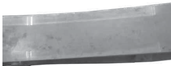
Рис. 1. Доріжка тертя на рейці зі значним зношуванням в місцях фреттинг-контакту
