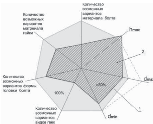
Рис. 5. Анализ комплекса свойств резьбовых крепежных систем с тарированным усилием сжатия пакета:
