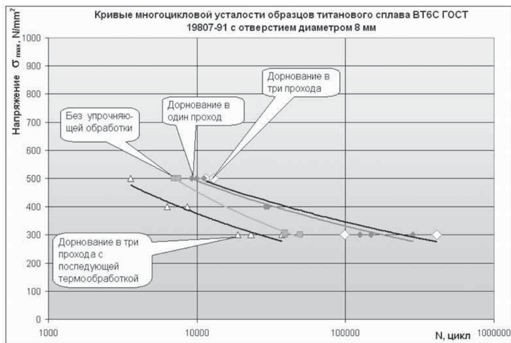
Рис. 6. Кривые усталости образцов титанового сплава ВТ6С с отверстием диаметром 8 мм (четыре группы)
