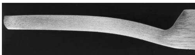
Рис. 6. Изгиб продольного сечения колодки парной 8-8-ОСТ 1.11554-74 при вальцовке
