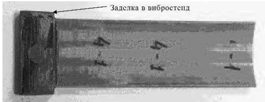
Рис. 3. Внешний вид образца, подготовленного к виброиспытаниям
