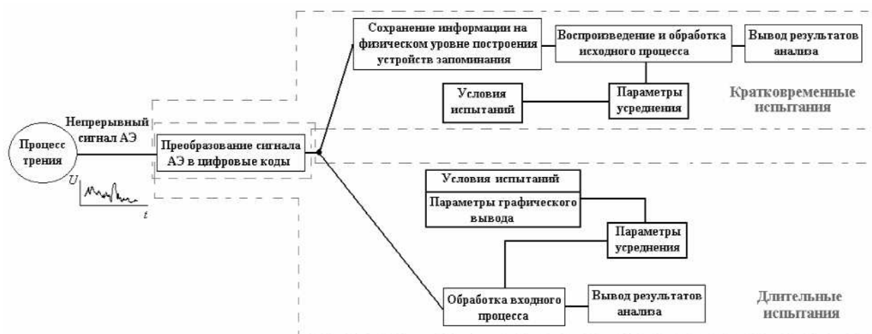
Рис. 1. Структура концептуальной части акусто-эмиссионных систем диагностики узлов трения
