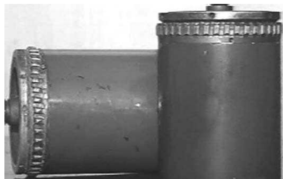
Рис. 6. Обтюраторные кольца СУР после полной обтюрации (эксперимент)
