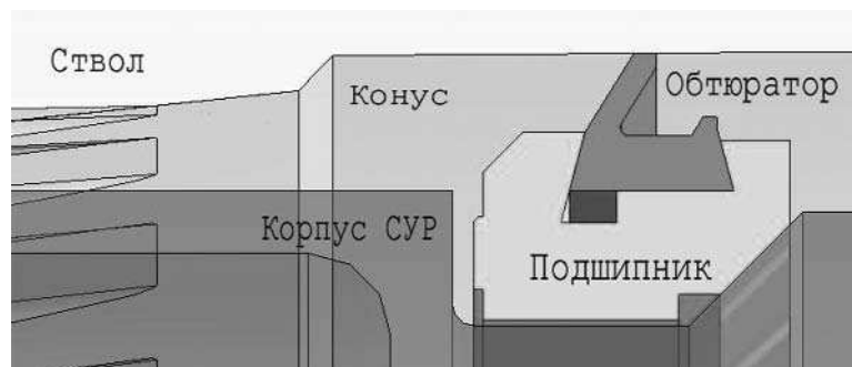
Рис. 1. Фрагмент геометрической трехмерной модели системы "ствол-ракета"
