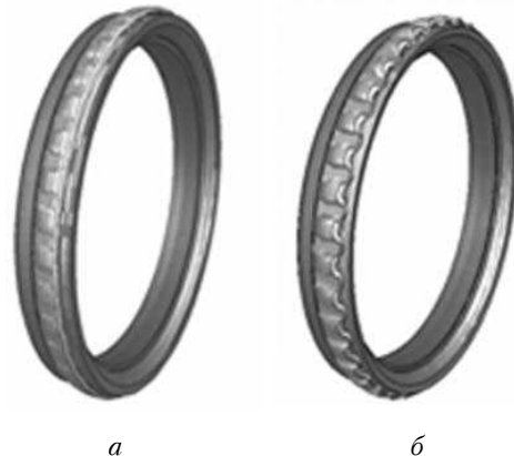
Рис. 5. Форма обтюраторного кольца в момент фиксации его в переходном конусе нарезной части ствола (а) и после полной обтюрации (б)
