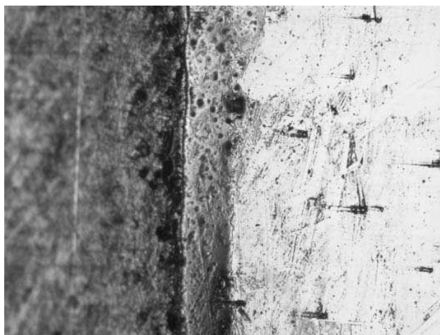
Рис. 9. Шар інтерметалідів, який створено в результаті пластичної взаємодії шарів алюмінію та сталі в різних зонах а та б по довжині заготовки
