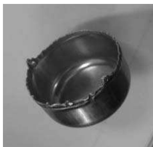
Рис. 8. Експериментальні зразки двошарових елементів сталь-алюміній:
