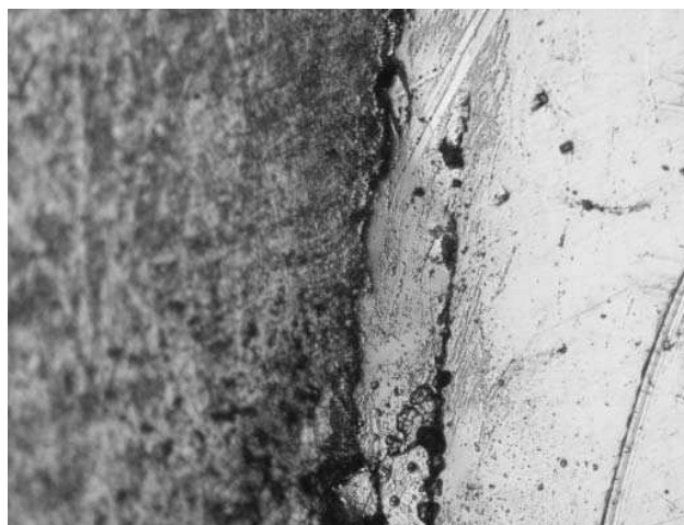
Рис. 9. Шар інтерметалідів, який створено в результаті пластичної взаємодії шарів алюмінію та сталі в різних зонах а та б по довжині заготовки
