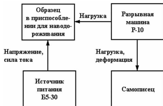
Рис. 3. Блок-схема проведения испытаний на растяжение
