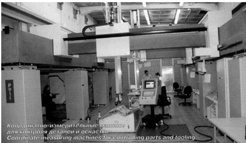
Рис. 9. Координатно-измерительный комплекс на базе КИМ ТСХ-8000 фирмы POLI (Италия) — НПК "Иркут"
