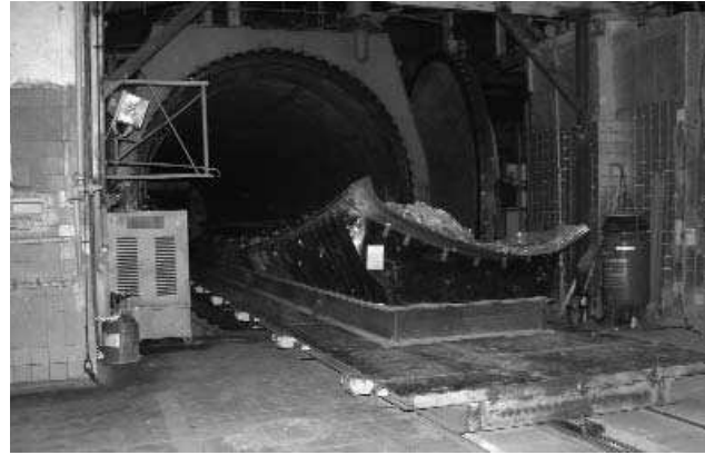
Рис. 13. Автоклав для производства интегральных конструкций из ПКМ широкофюзеляжного транспортного самолета Ан-124
