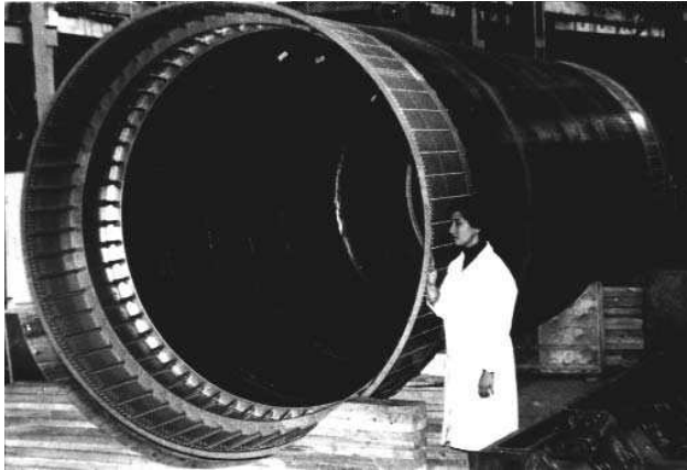
Рис. 9. Экспериментальный отсек фюзеляжа трехслойной конструкции из углепластика
