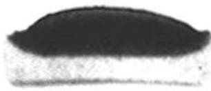
Рис. 7. Утворення остатку коксу на поверхні моделі теплозахисного призначення виготовленої із ПКП системи "РІПОР-ТРГ", при концентрації 2,5% ТРГ
