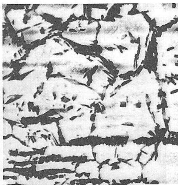
Рис. 5. Участок ЗТВ сварных швов из стали X2CrNiMoN22-5-3, выполненных аргоно-дуговой сваркой вольфрамовым электродом: a ) по слою активатора ПАТИГ С-А (содержание \delta -феррита 81,8 %) и б ) по слою активатора ActivaTec 500 (содержание \delta -феррита 70,1 %).
