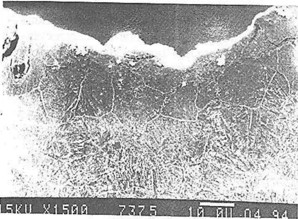
Рис. 8. Обезуглероженный слой, x 1500
