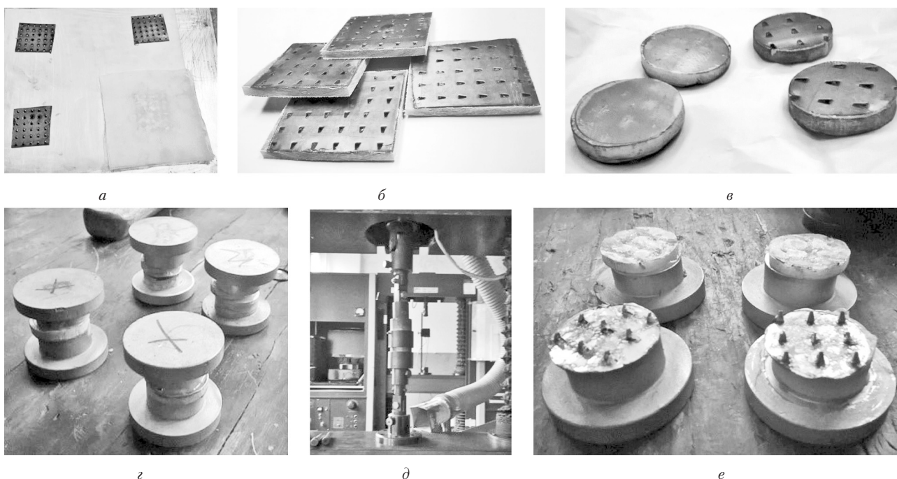
Рис. 5. Изготовление образцов и проведение испытаний на отрыв
