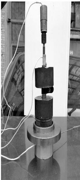
**Рис. 4.** Приспособление для измерения кругового электросопротивления
