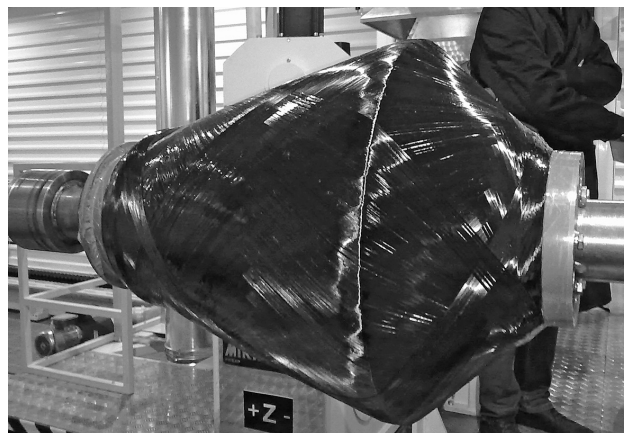
Рис. 14. Раструб после намотки армирующей оболочки
