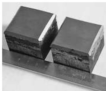
Рис. 1. Внешний вид наплавленных образцов для испытаний термической стойкости
